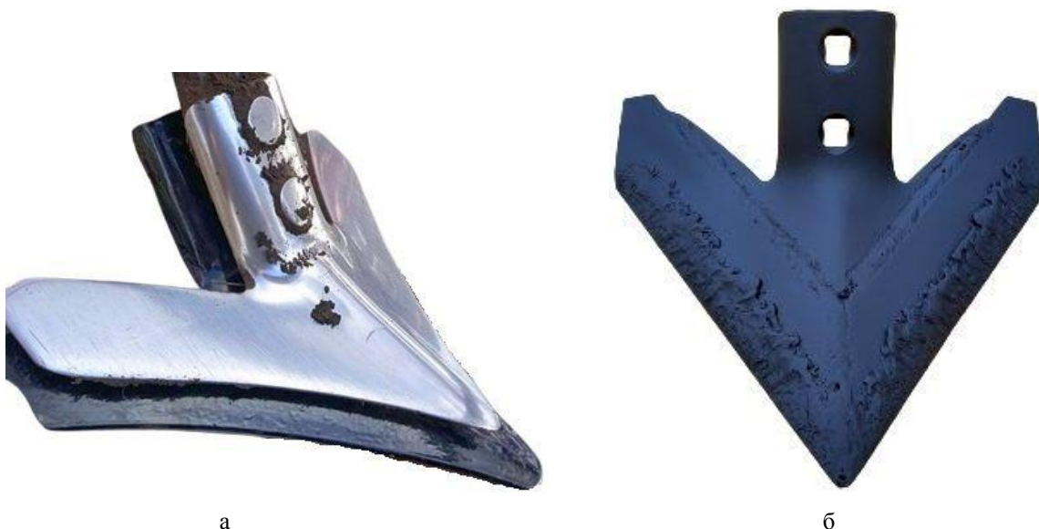
Рисунок – Зношена лапа культиватора CASE Tiger-Mate в порівнянні з новою а) і відновлена та зміцнена за технологією ІМА АПВ НААН б)
