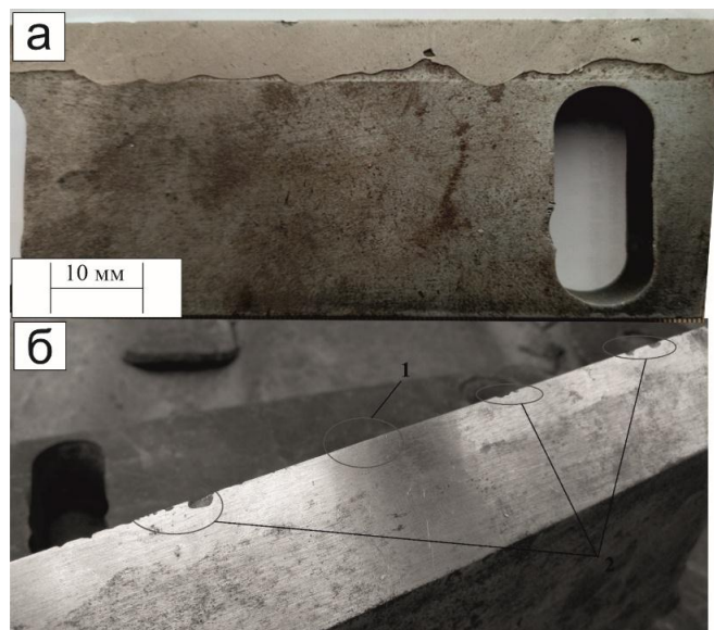
Рисунок 1 – Загальний вигляд ножа (а) та контрножа (б) для переробки пластикових відходів
