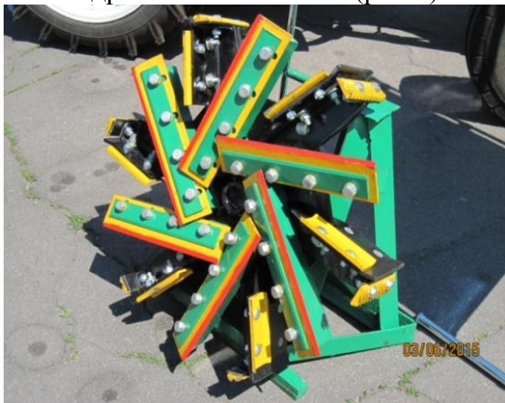
Рисунок 1 – Зразок з додатковими ножами модернізованої кидалки
